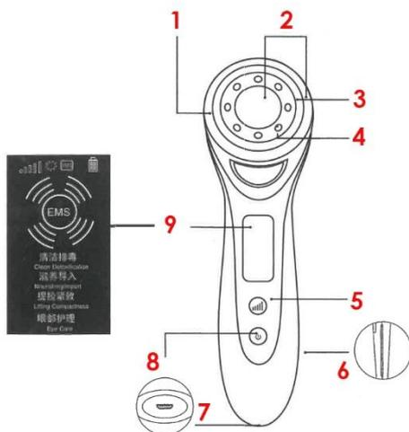
1. Anel de fixação de algodão para maquiagem; 2. Cabeça de massagem; 3. Abajur; 4. Luzes LED; 5. Ajuste de temperatura; 6. Tira de indução de íons; 7. USB; 8. Botão liga/desliga/interruptor de modo; 9. Tela de exibição de operação.
